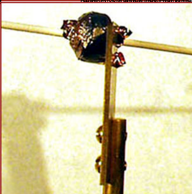
2. Schritt: Das Kupferblech wird über den Kugelnkörper gezogen.
