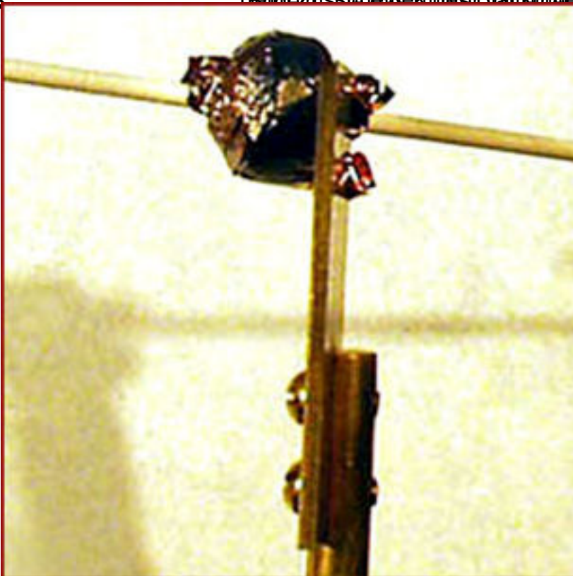
2. Schritt: Das Schmelzblei des Blattkupfers wird mit einem Solderwerkzeug auf die Pad des Bauelements aufgetragen.
